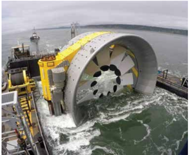
▲ Hệ thống điện thủy triều
