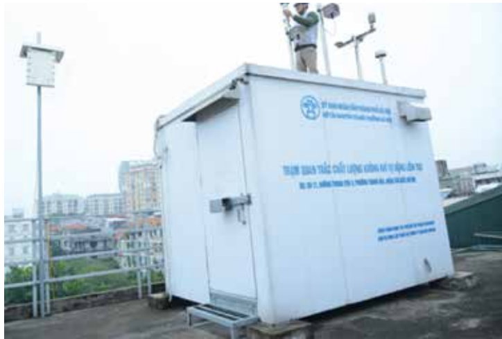
▲ Trạm quan trắc chất lượng không khí tự động, liên tục tại Hà Nội
