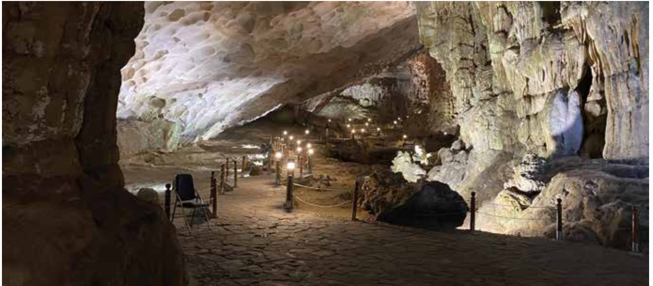
▲ Hệ thống ánh sáng kích thích sự phát triển của thực vật đèn (Lampenflora) trên hệ thống nhũ đá trong hang karst
