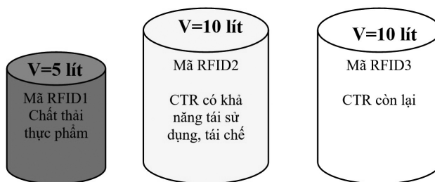
Hình 2. Ba loại thùng chứa CTRSH được dán mã RFID
