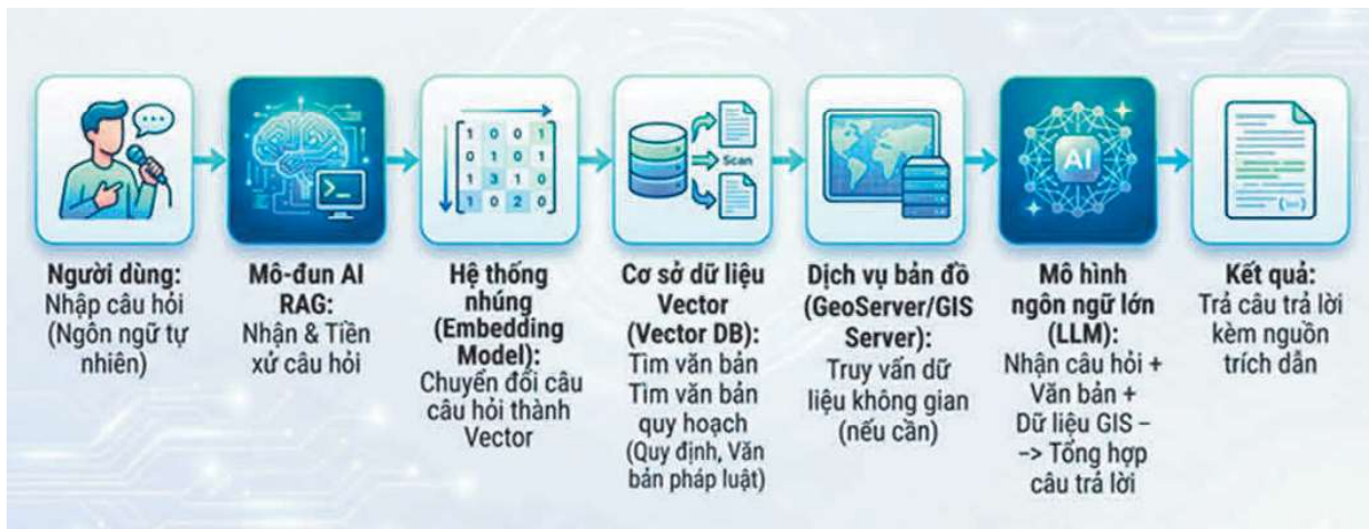
Hình 3. Luồng xử lý AI theo hướng RAG cho tra cứu thông tin quy hoạch
