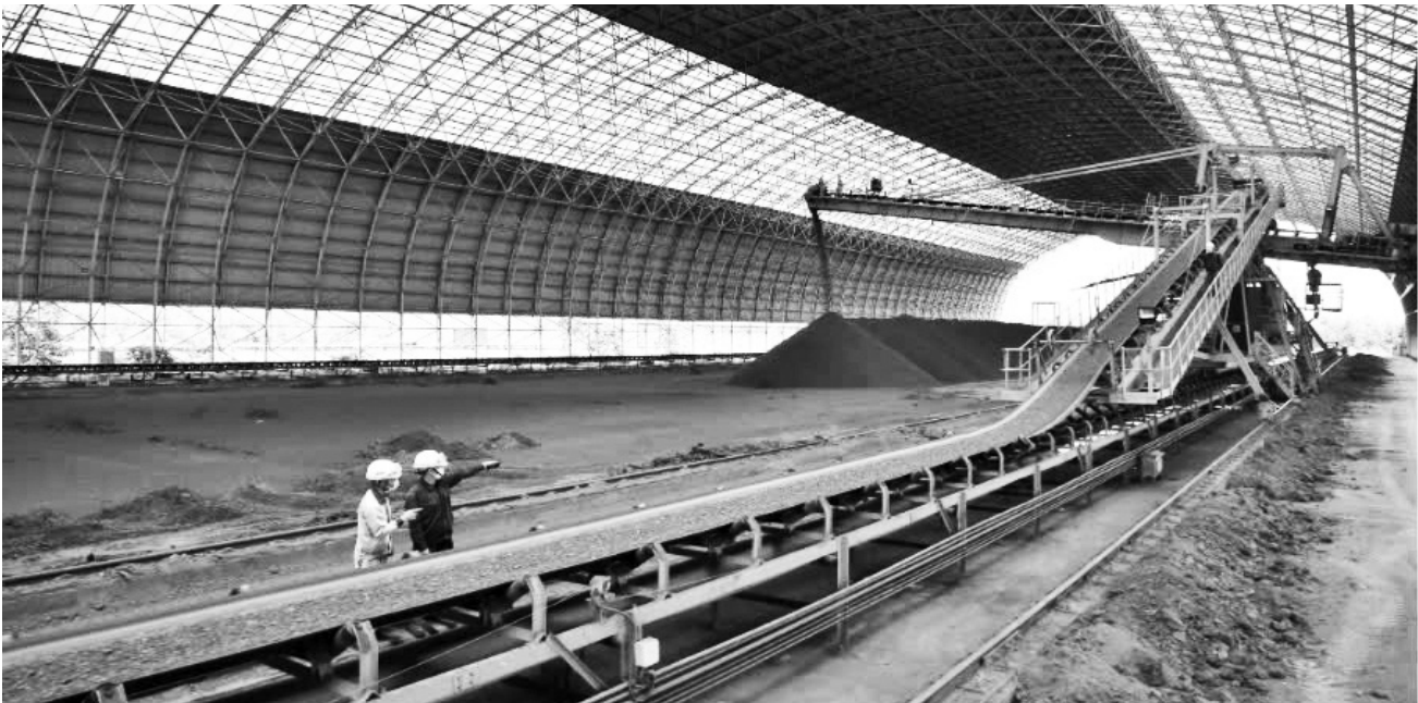
Hình 4. Vận tải bằng băng tải trên mỏ bô xít
