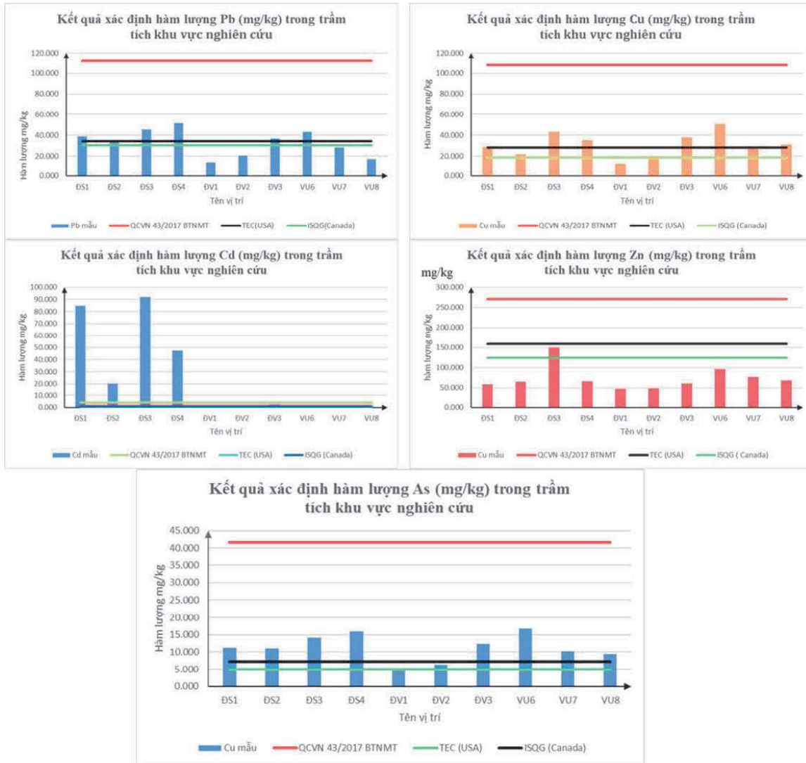
Hình 2. Biểu đồ thể hiện hàm lượng của các kim loại nặng so với các tiêu chuẩn tại khu vực Hải Phòng
