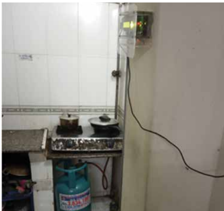
▲ Máy đo CLKK sử dụng cảm biến được đặt gần bếp để theo dõi nồng độ bụi PM_{2.5} trong quá trình nấu ăn
