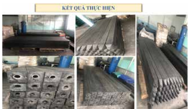
▲ Hình 7a. Cọc composite PE/trấu được sử dụng để xây dựng thử nghiệm công trình chống sạt lở
