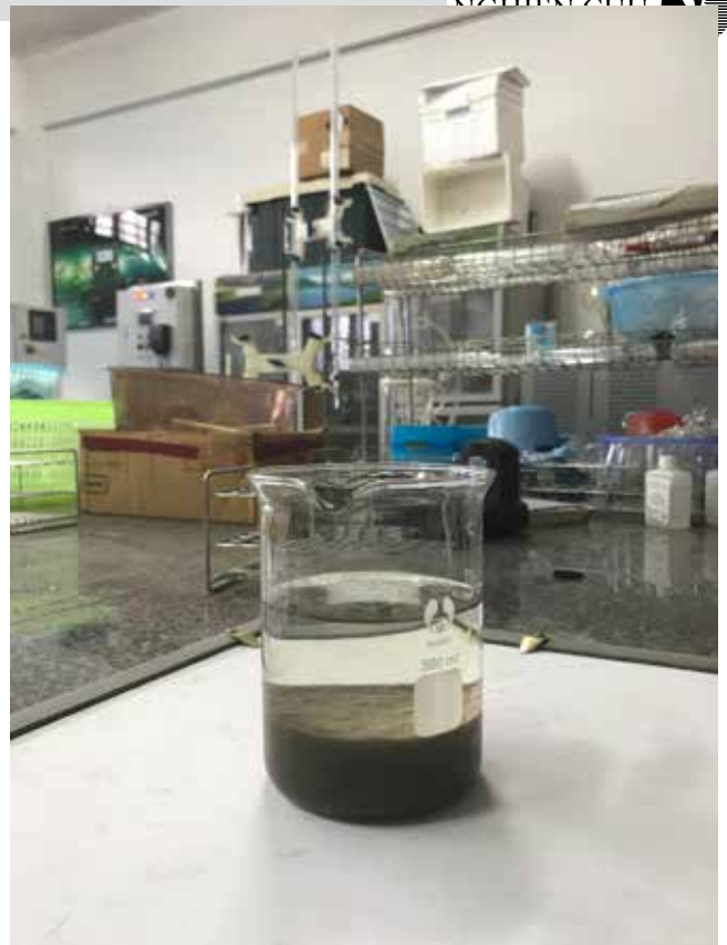
▲ Hình 2b. Bùn hoạt tính lấy từ trạm XLNT
