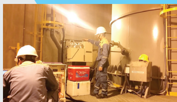
▲ Lấy mẫu khí thải ống khói bằng thiết bị ISOKINETIC
