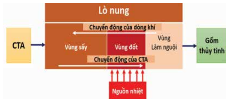
▲ Hình 3. Sơ đồ sử dụng lò nung gạch tuynel để xử lý nhiệt tái kết tinh có kiểm soát
