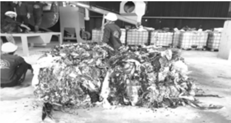
▲ Rác ni lông phân loại sẽ được ép kiện rồi đưa vào lò quay nhiệt phân kín
