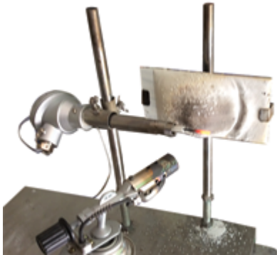
▲ Đốt thử nghiệm mẫu sơn chống cháy KOVA. Bề mặt vật liệu được bảo vệ, kéo dài thời gian chịu nhiệt.
