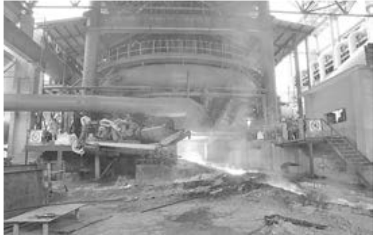
▲ Công nghệ sản xuất gang Lò cao từ quặng sắt
