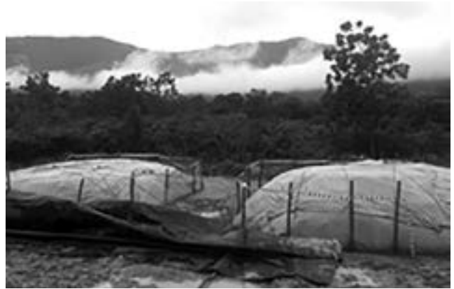
▲ Hình 3. Hai khối đất được ủ kỵ khí tại hiện trường
