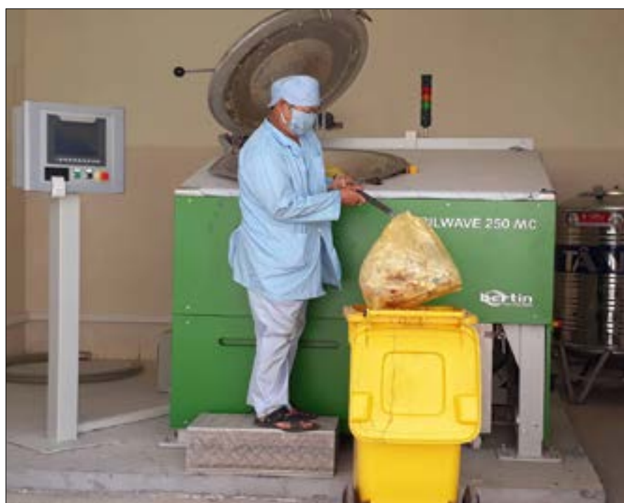
▲ Xử lý chất thải rắn y tế bằng công nghệ vi sóng (không đốt) tại Bệnh viện Đa khoa tỉnh Cao Bằng
