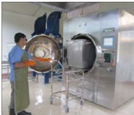
▲ Công nghệ xử lý chất thải rắn y tế nguy hại bằng công nghệ tiết trùng, cất nghiền
