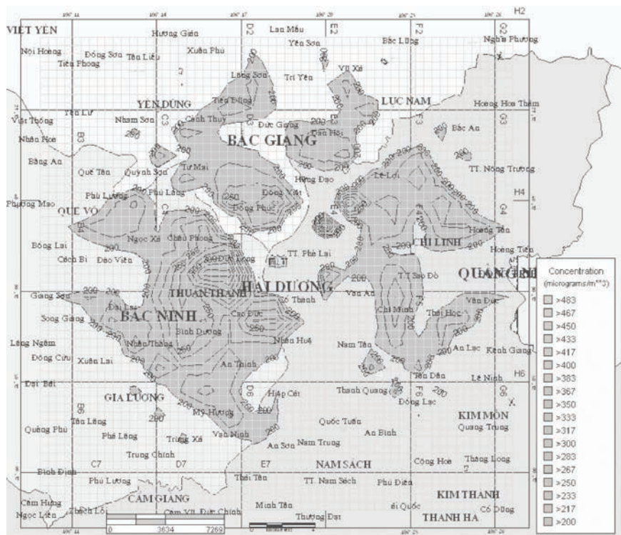
▲ Hình 2. Phân bố nồng độ khí \text{NO}_2 khu vực xung quanh Công ty CP Nhiệt điện Phai Lai (Trường hợp không thực hiện biện pháp xử lý khí)
